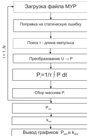
Рисунок 2. Алгоритм пакетной обработки
