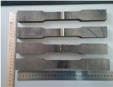
Рис. 4. Образцы до испытаний.
