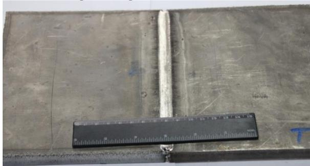
Рис. 2. Обратная сторона сварного соединения титанового сплава.
