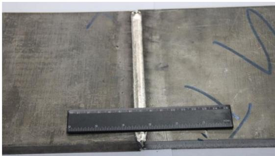
Рис. 1. Лицевая сторона сварного соединения титанового сплава.
