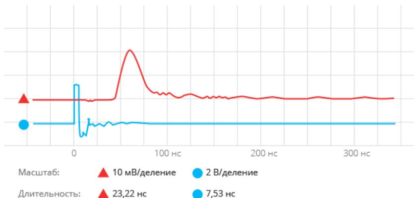
Рис.2. Временная развёртка импульса ЛД (треугольник) и задающего генератора (круг).
