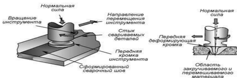
Рис.1. Схема сварки трением перемешиванием
