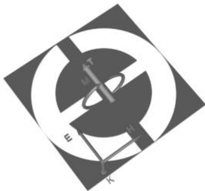
Рис. 1. Модель метамолекулы. M , T - магнитный и тороидный моменты. K - направление распространения электромагнитной волны, E и H - электрическая и магнитная составляющие.
