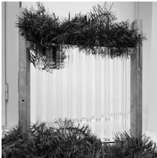
Рис. 1. Метаматериал на основе трубочек, заполненных водой
