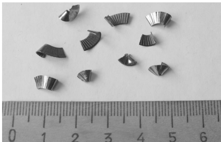
Рис. 2. Элементы стружки, образованные при сверлении глубоких отверстий
