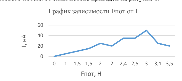
Рис. 1. Графическое отображение результатов расчетов в виде зависимости интенсивности светового потока от силы потока жидкости
