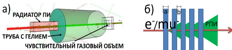
Рис.1. а) Визуализация детектора на ПИ в программном пакете GEANT4. Пучок электронов попадая в радиатор ПИ генерирует РПИ, далее электроны и фотоны проходят через трубу, наполненную гелием и регистрируются в детектирующем объеме. б) Схема генерации РПИ в радиаторе. Радиатор — это многослойная структура, состоящая из M фольг толщиной a (синим) и вакуумных (воздушных) зазоров толщиной b между ними, зеленые конусы символизируют ПИ.
